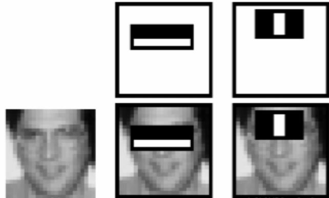
Fig 8.Face Detection using Haar Cascades
